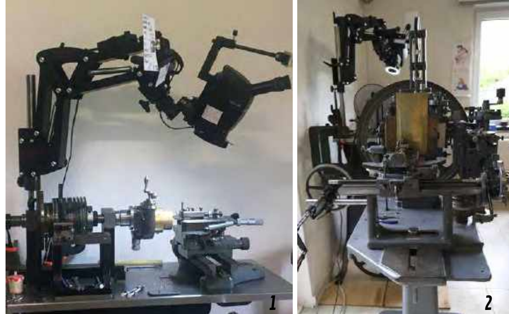
Ferramentas tradicionais: 1. Máquina de linha reta para gravar linhas retas 2. Máquina de rosa para gravuras circulares
