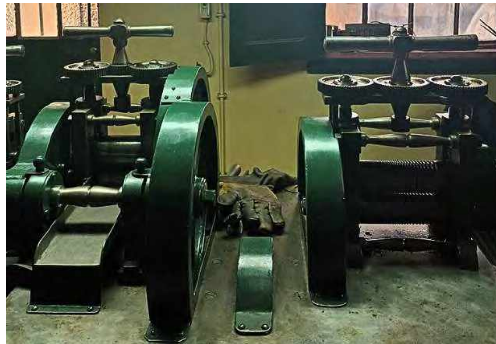
Tradycyjne narzędzia: maszyna do ciągnięcia drutu (po prawej) i laminator .
